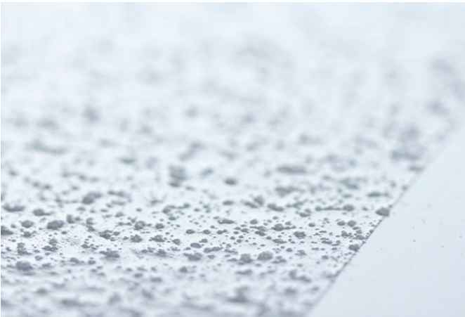
الطلاء المقاوم للانزلاق GriP AntiSlip®, مكبر 20 مرة. GriP AntiSlip® coating, magnified 20 times.
